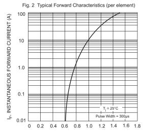
$V_{F}$ , INSTANTANEOUS FORWARD VOLTAGE (V)
